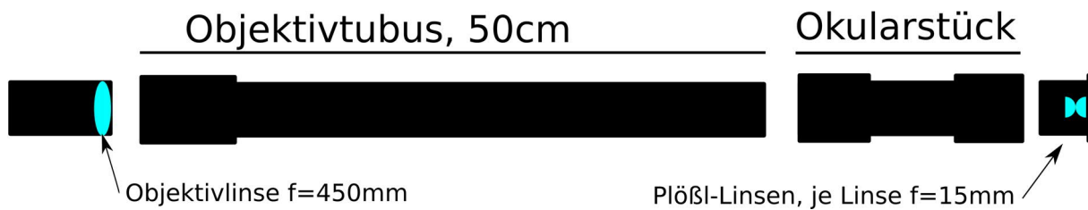
Abb. 2: „Explosionsansicht“ des Teleskops: Das Rohrstück links steckt im Tubus, die Muffe rechts im Okularstück. Dieses steckt locker auf dem Objektivtubus, so dass es sich leicht bewegen lässt.
