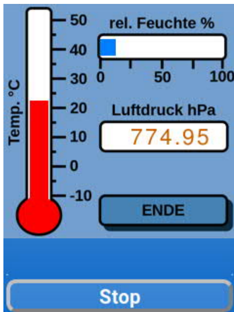
Abb. 6: Auswertung des I2C-Sensors BME280
