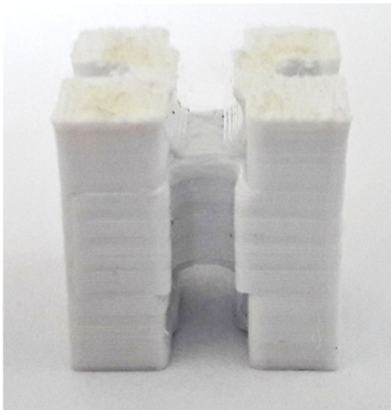
Abb. 4: Druckergebnis mit Lüfter
