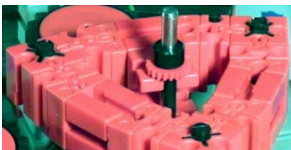
Abb. 20: Sicherung des Innenläufers gegen Verdrehen
