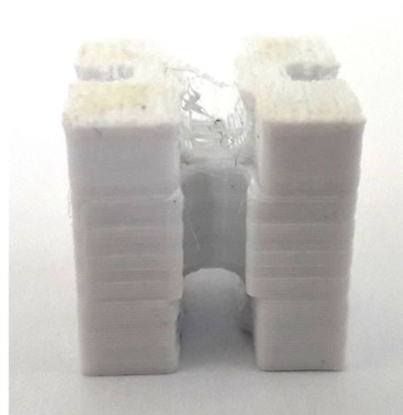
Abb. 5: Druckergebnis ohne Lüfter
