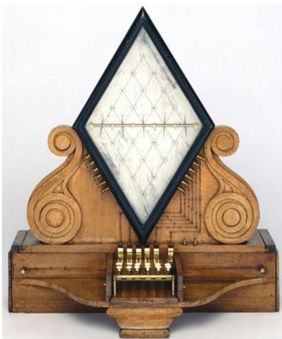
Abb. 6: Nadeltelegraf von Charles Wheatstone und William Forthergate Cooke (1837)
