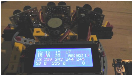
Abb. 7: Beispiel für ein Text-LCD mit 4 Zeilen à 20 Zeichen, ergänzt um eine I 2 C-Interface-Platine (auf der Unterseite angelötet)
