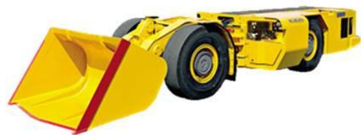
Abb. 1: Schopf-Bergbau-Radlader SFL 60 XLP [1]
