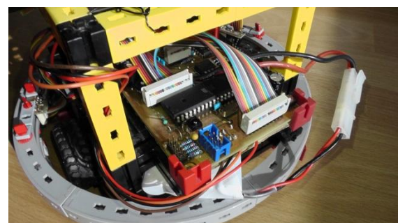
Abb. 6: So kann das Mikrocontrollerboard in ein ft-Modell eingebaut werden.
