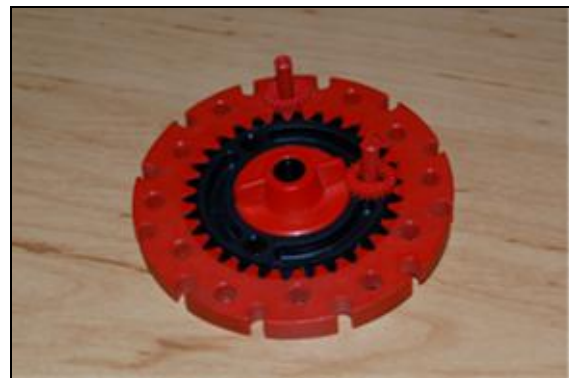
Bild 8: Die beiden Zahnräder können gegeneinander verdreht eingesteckt werden
